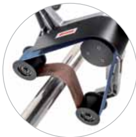
Kąt opasania (270°) zapewniający dużą wydajność
