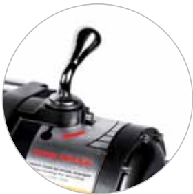
Dźwignia sprzęgła obracająca się o 180°
