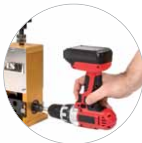
Zamiana korby na wiertarkę lub wkrętkarkę pozwalająca zautomatyzować i przyspieszyć pracę
